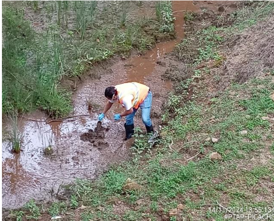
Toma de muestra fango seco (evaporado) en el área actual de descarga de lodos de la PTAP El Picacho
