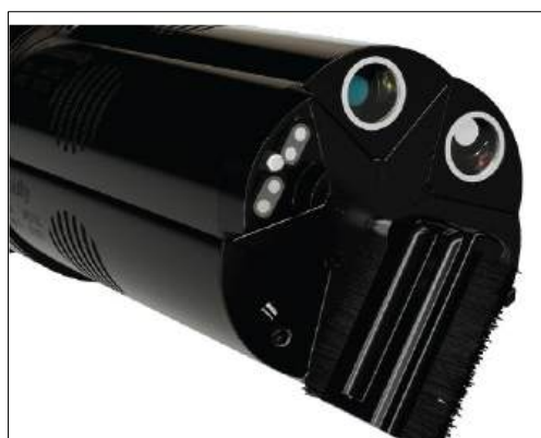
Figura 5. Imagen de puerto de ubicación de los sensores dentro del instrumento multiparamétrico.
