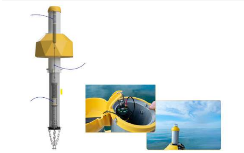
Figura 6. Imagen de boya tipo para instalación del instrumento multiparamétrico.
