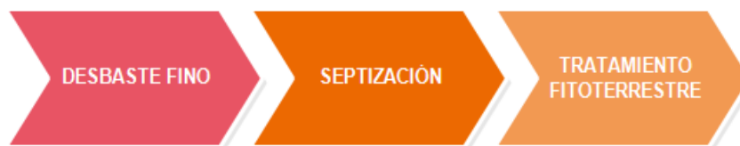
Figura 11. Diagrama de funcionamiento humedales artificiales
